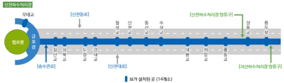
[그림 2-4] 신천유지용수 송수관로·수위유지보 설치현황
