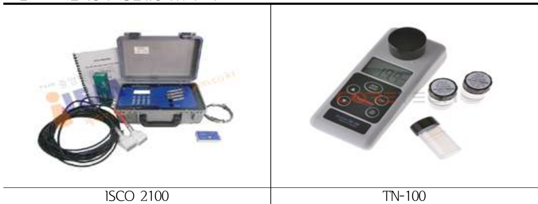
[그림 2-15] 이번 측정에 사용된 유량계 및 탁도계
