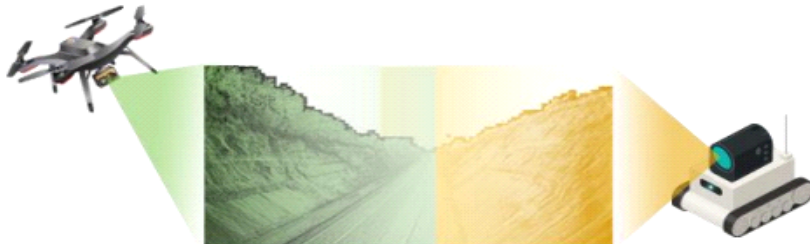
[그림 4-31] 이중 플랫폼 및 센서, 다른 처리방식으로 얻어진 데이터를 이용한 측량 개념도
