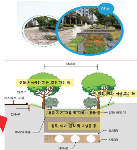
- 식생체류지 도입 예시 및 구조적 기능 모식도 -
