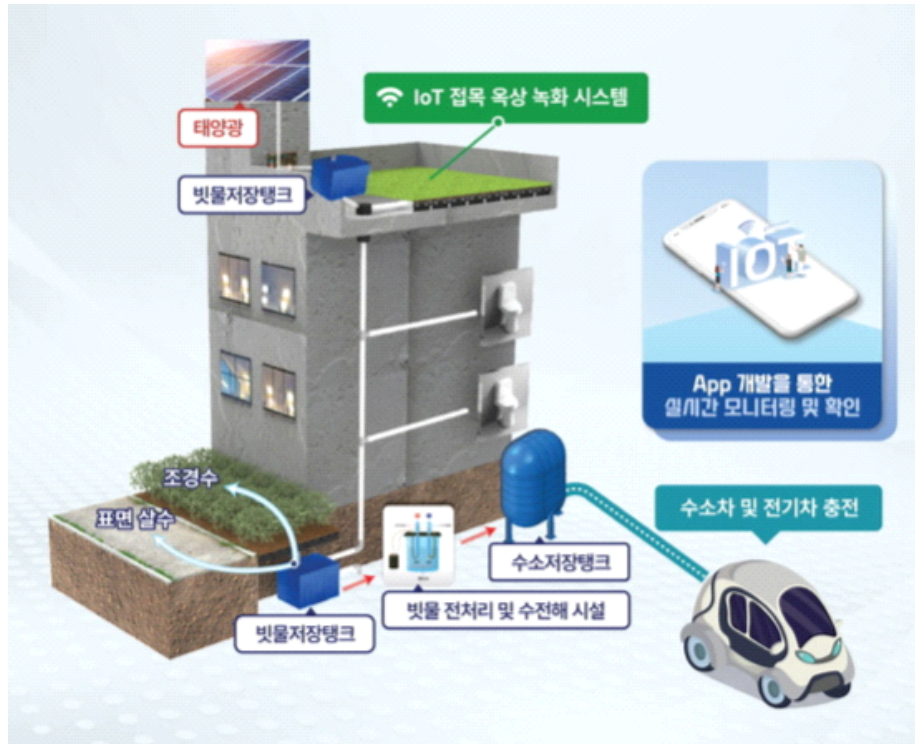
[그림 1-1] 기후위기 대응을 위한 옥상 빗물저금통 활용 건물 통합녹화시스템 모식도
